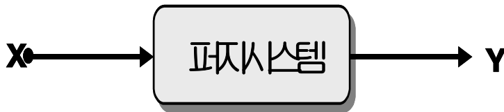
그림 2.2 단일 입력 - 단일 출력 퍼지시스템
