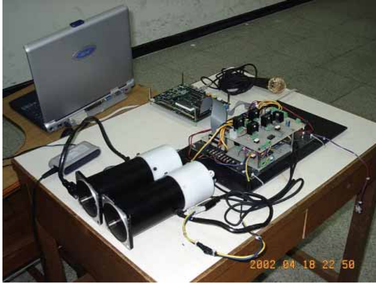
부록 3. 음성인식 모듈을 이용한 DC 모터 구동장치 사진
