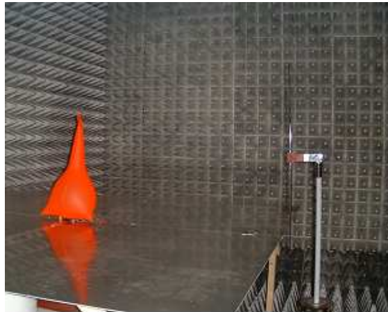
그림 4.14 Sonobuoy 송신기의 전력밀도 측정
