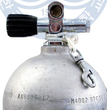
그림. 9 사이드마운트 시스템 밸브에 볼트스냅 조립
