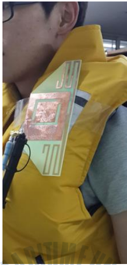
Fig. 27 구명조끼에 장착된 PLB, GPS 안테나의 모양
