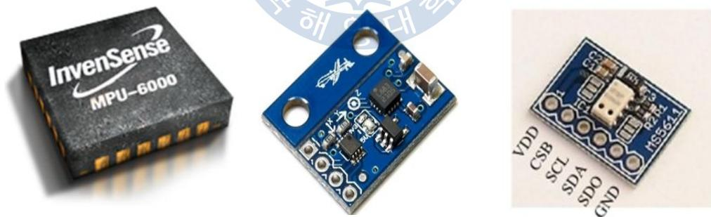
그림 3-5. MPU-6500, HMC05883L, MS5611
