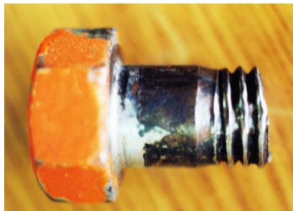
(c) 내측 시점부 앵커볼트의 파단 사진
