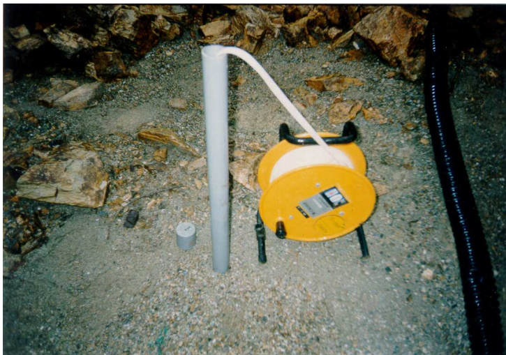
사진 3.8 지하수위계 설치완료 후 모습
