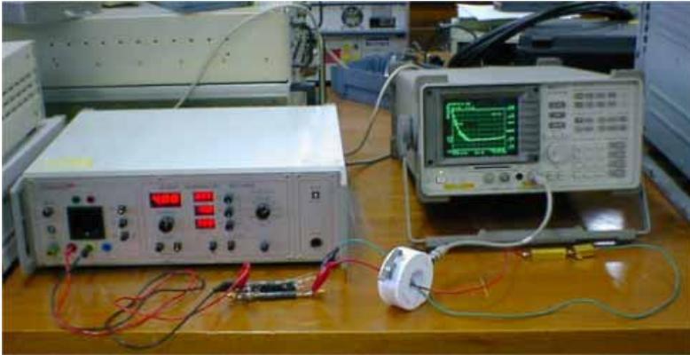
그림 4. 7 IEC 61000-4-4에서의 광대역 EMC 필터 분석 장면
