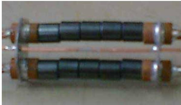
그림 3. 7 제작한 광대역 EMC 필터의 사진
