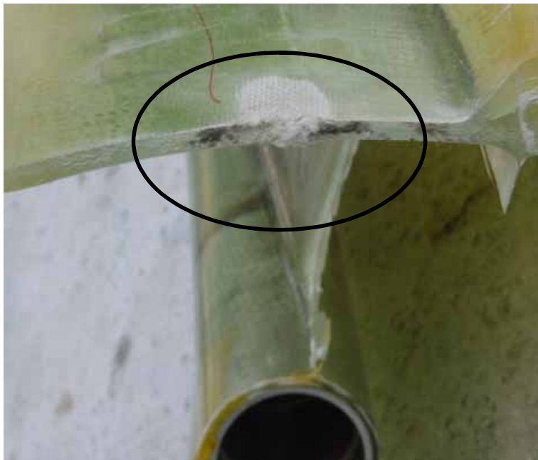
(d) Defect by resin starvation
