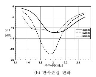
그림 3-7. 이중옵셋 개구결합 급전 안테나의 슬롯길이(ℓ<sub>s</sub>) 변화에 따른 안테나 입력임피던스 변화 (ℓ<sub>p</sub>=52mm, w<sub>p</sub>=66mm, h=20mm, d=30mm, s=2.5mm×2.5mm, ℓ<sub>stub</sub>=16mm)
