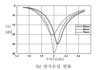
그림 4-3. 3차원 급전 안테나의 패치 길이 변화에 따른 안테나 입력 임피던스 및 반사손실 변화
