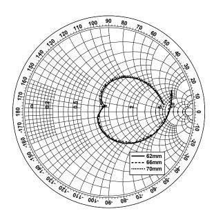
그림 3-5. 이중옵셋 개구결합 급전 안테나의 패치 폭 변화에 따른 안테나 입력 임피던스 변화 (ℓ<sub>p</sub>=52mm, h=20mm, ℓ<sub>s</sub>=50mm, d=30mm, s=2.5mm×2.5mm, ℓ<sub>stub</sub>=16mm)
