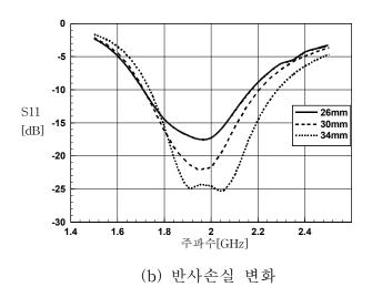
그림 3-8. 이중옵셋 개구결합 급전 안테나의 급전선 사이의 간격(d) 변화에 따른 안테나의 입력임피던스 및 반사손실 변화 ( $\ell_p$ =52mm,  $w_p$ =66mm, h=20mm,  $\ell_s$ =50mm, s=2.5mm ×2.5mm,  $\ell_s$ tub=16mm)
