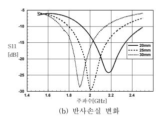
그림 4-7. 3차원 급전 위치( $D_3$ ) 변화에 따른 안테나의 입력임피던스 및 반사손실 변화
