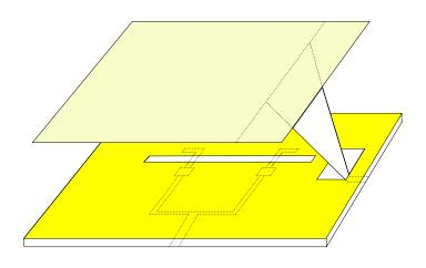
그림 2-3. 이중옵셋 개구결합 급전과 3차원 마이크로스트립 급전을 이용한 마이크로스트립 패치 안테나의 구조
