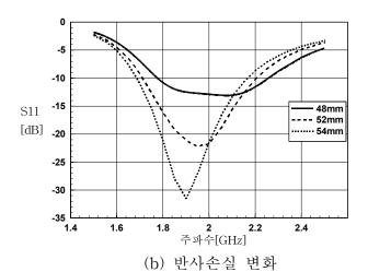
그림 3-4 이중옵셋 개구결합 급전 안테나의 패치 길이 변화에 따른 안테나 입력임피던스 및 반사손실 변화 (wp=66mm, h=20mm, ℓs=50mm, d=30mm, s=2.5mm×2.5mm, ℓstub=16mm)
