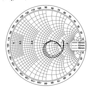
그림 4-4. 3차원 급전 안테나의 패치폭 변화에 따른 안테나 입력 임피던스 변화
