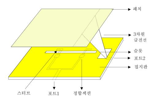
그림 5-1. 이중옵셋 개구결합 급전과 3차원급전을 이용한 마이크로스트립 패치 안테나의 구조
