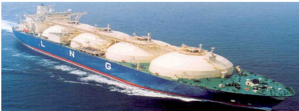
[그림 3-36] Moss형 LNG선 (Oceanpia호)
