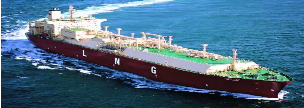
[그림 3-38] Membrane형 LNG선(Summit호, GT Type)
