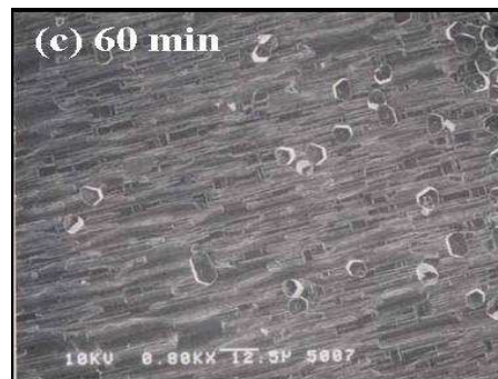
그림 4-10 후막 두께 변화에 의한 GaN 표면 SEM 형상
