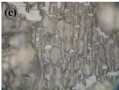
그림 4-5 질화 처리 후 후막 GaN의 표면 광학 현미경 형상 질화 처리 온도:(a)550 °C (b)600 °C (c)650 °C (d)700 °C
