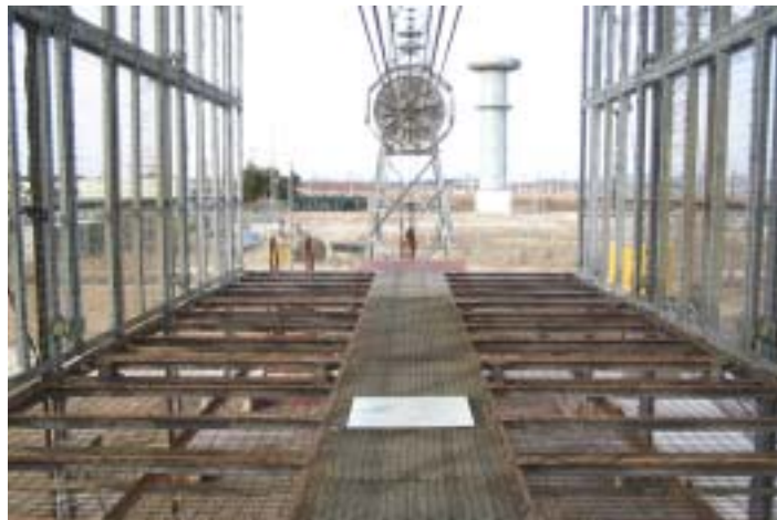
그림 4.19 코로나 케이지의 이온전류밀도 측정용 평판전극 Fig. 4.19 Measuring plane electrode for ion current density
