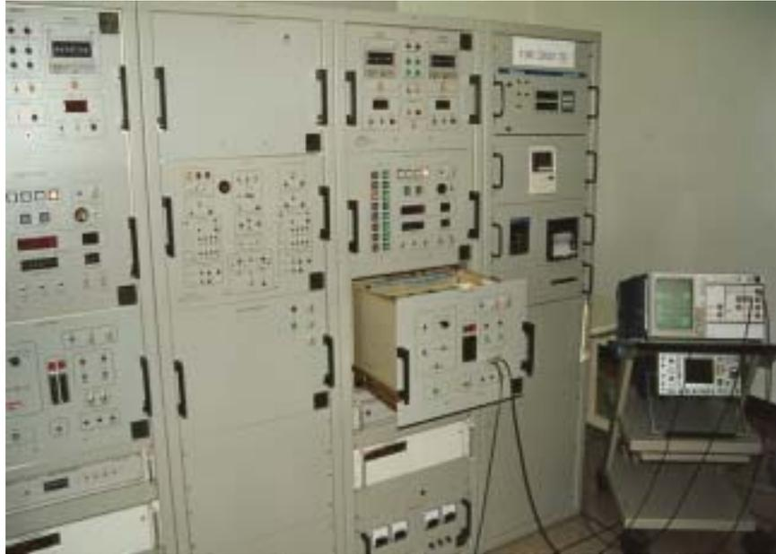
그림 5.2 포항 Loran-C 송신국의 EUROFIX 시스템
