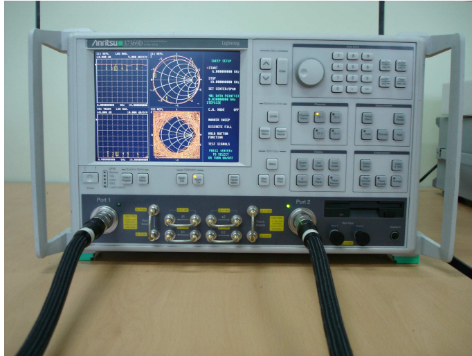
그림 2.11 Anritsu 37369D 네트워크 아날라이저 Fig. 2.11 Anritsu 37369D Network Analyzer.
