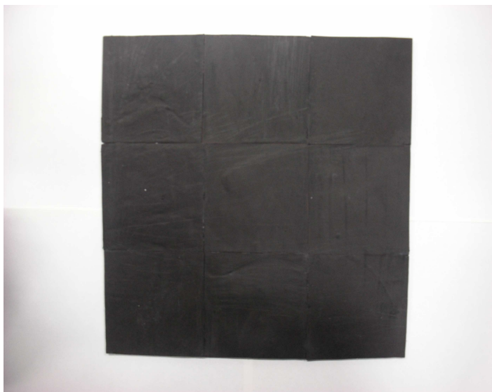
그림 3.20 30 cm × 30 cm의 크기로 제작된 전파흡수체
