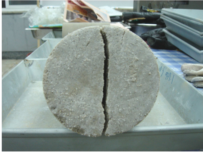
Fig. 4-11 간접인장실험으로 파괴된 동결토의 모습
