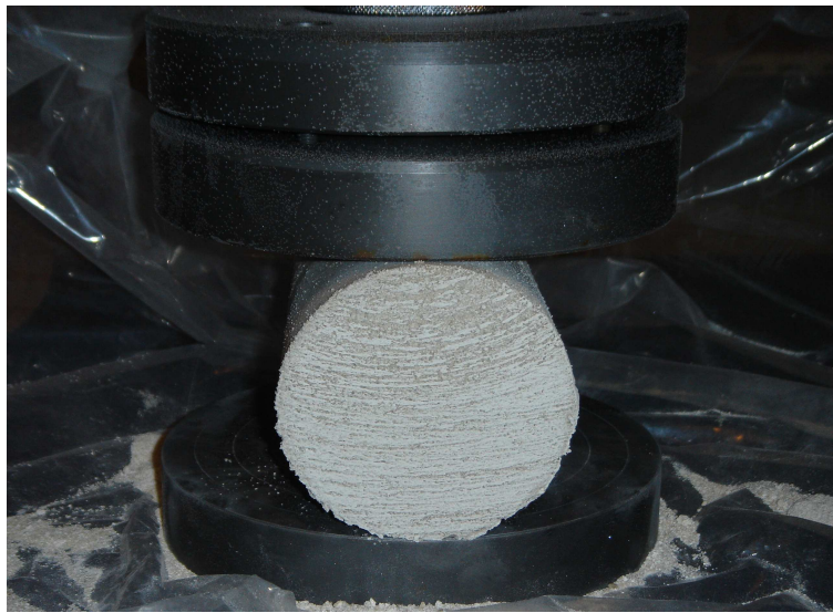
Fig. 4-10 간접인장시험의 시편 설치 모습
