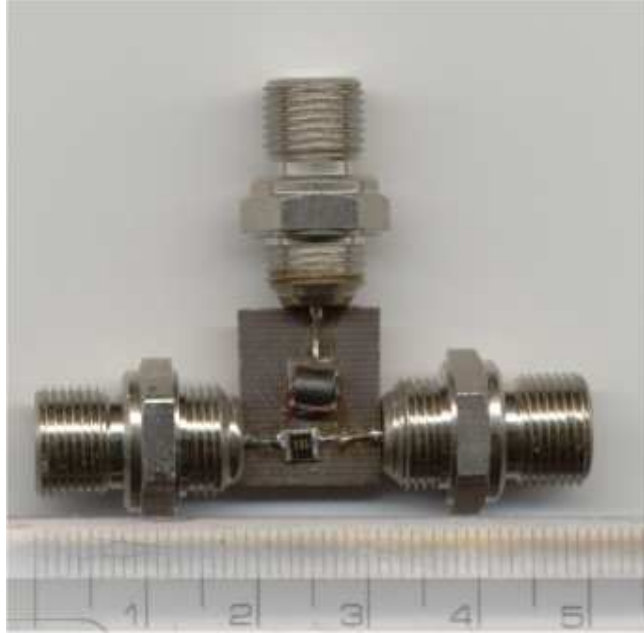
그림 3.9 제작한 원형의 신호분배기 Fig. 3.9 The transformer type power splitter of the proto-type.
