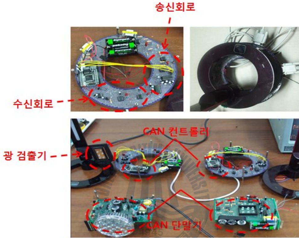
<Fig.14> CAN 통신을 적용한 가시광 조명통신 시스템 구성도
