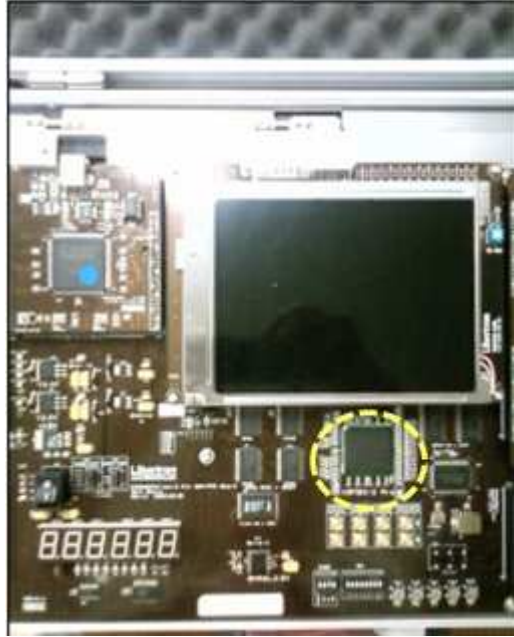
그림 4-16. 구현에 사용한 FPGA 칩(Vertex II Pro xc2vp30-5)
