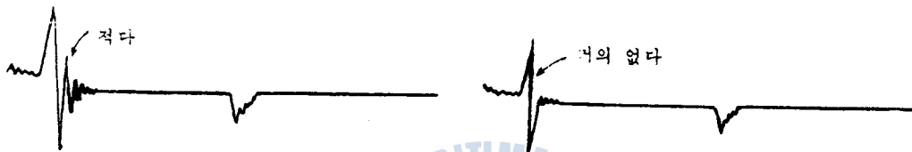
第6圖 點火코일卷線間이 短絡되었을 때 또는 콘덴서 漏電이 있을 때의 2次波形 點火코일이나 콘덴서의 絶緣이 높을 때는 上記한 것과 反對의 現象이 일어난다.
