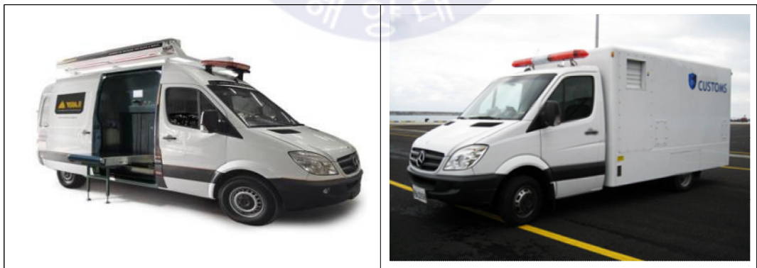
이동형 수하물 엑스레이 검색차량(좌) 21) 및 이동형 컨테이너 엑스레이 검색차량(우) 22)
