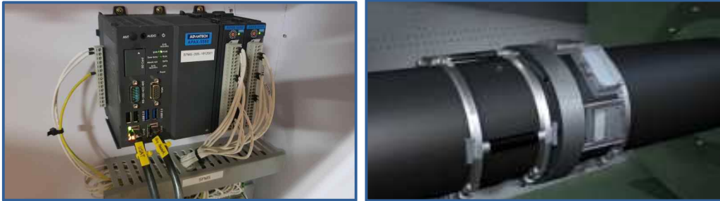
<그림 4-4> 데이터 수집 장치 및 축마력계 설치 모습
