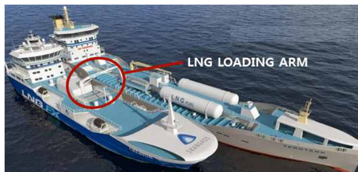
Fig. 2.4 LNG loading arm (Carolina, 2017).
