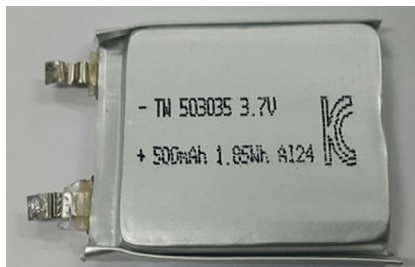
Fig. 29 Li polymer battery(3.7V 500mAh)
