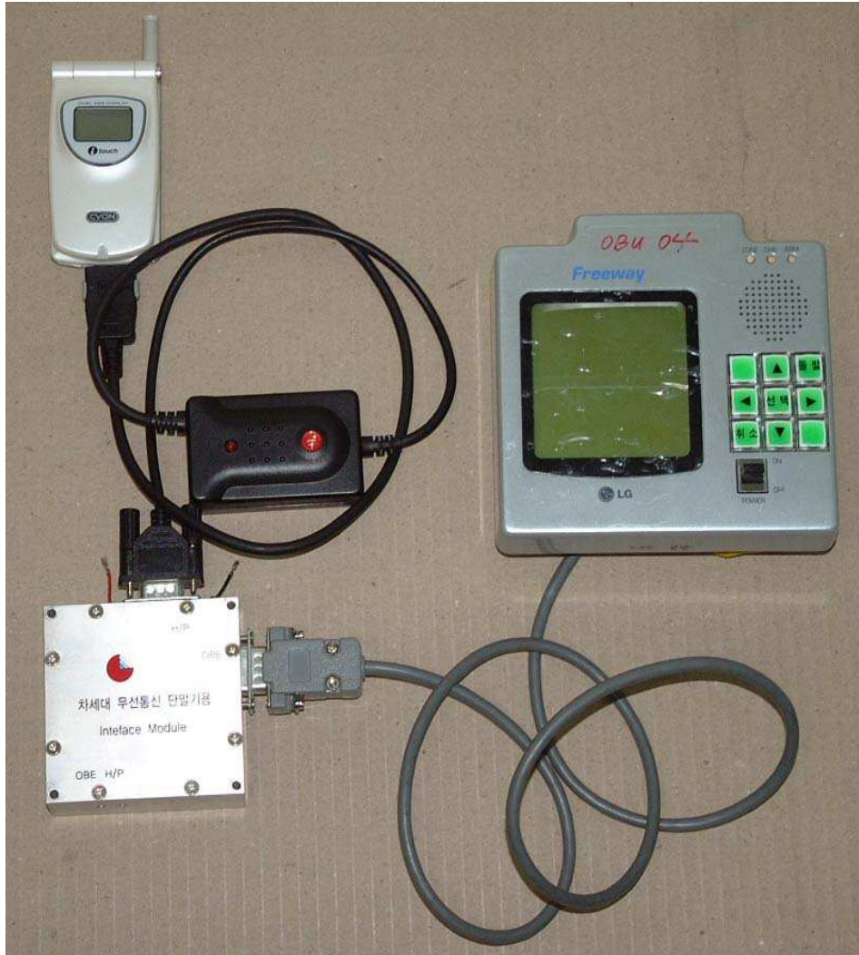
<그림 5-18> 휴대폰을 이용한 ETC 시스템 구성 <Fig. 5-18> Configuration of ETC system using mobile phone
