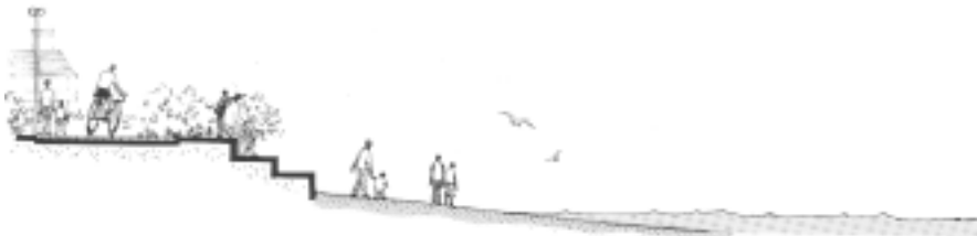
계단형태의 호안은 친수성의 확보와 모래가 날아오는 것을 막아준다.
