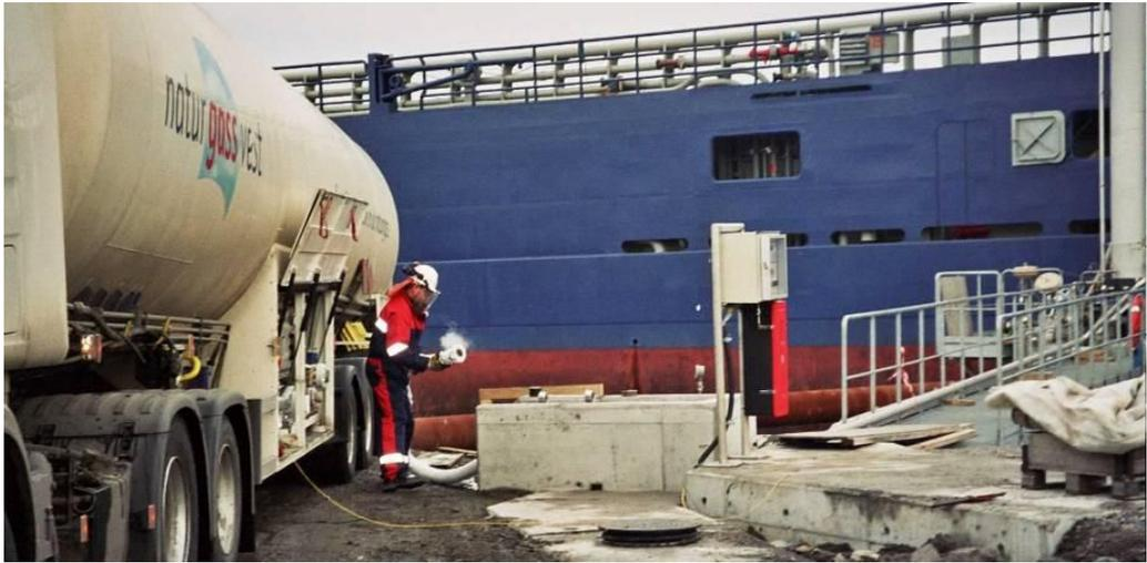
그림 4-3: 탱크로리를 이용한 LNG 충전<sup>30</sup>
