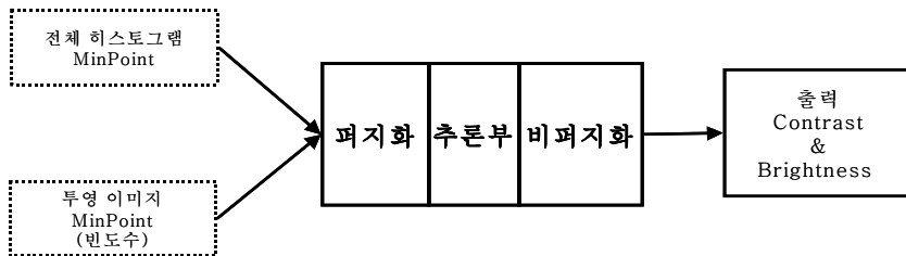
그림 30. 퍼지 추론을 이용한 명도와 대비값 추출
