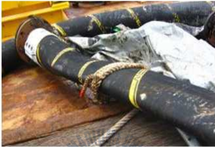
Fig. 18 잔존유 회수작업 중 유회수용 호스가 압착된 모습
