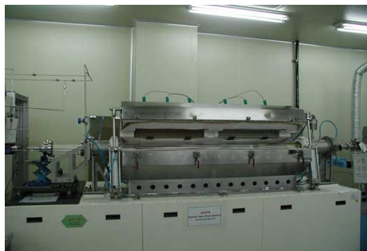
그림9. MS- HVPE의 HVPE 장비의 실제 사진
