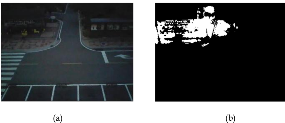
그림 4.2.2 광원의 작동상태에 따른 전경 추출 실험 결과 영상
